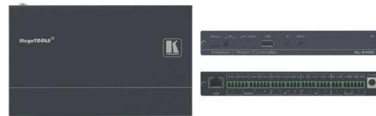
**Le SL-240C est un contrôleur de salle/principal compact (automate Kramer Control) avec PoE.** Il peut fonctionner via Ethernet avec des ports de contrôle qui incluent : 4 RS-232 bidirectionnels, 4 IR, 4 GPIO et 4 relais. Il contrôle des équipements tels que des scalers, affichages vidéo, amplificateurs audio, lecteurs Blu-ray, capteurs, écrans, stores, serrures et lumières. Plusieurs passerelles de contrôle Ethernet Kramer peuvent être utilisées pour ajouter des ports I/O distants.
