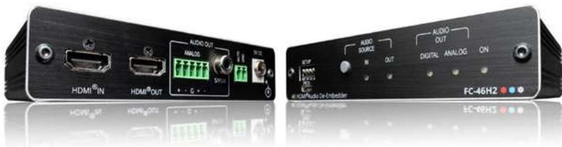
**Le FC-46H2 est un déembeddeur audio professionnel pour signaux HDMI d'une résolution maximale de 4K à 60Hz (4: 4: 4).** L'unité déembedde le signal audio de l'entrée HDMI ou de la sortie HDMI ARC (Audio Return Channel) et le transmet simultanément aux sorties S / PDIF® et audio symétriques à 5 broches.
